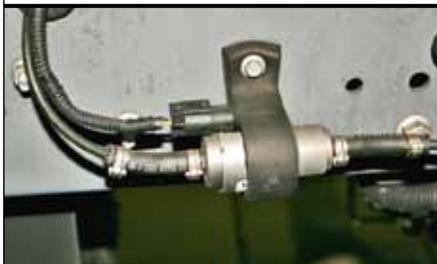
**Для питания автономного отопителя предусмотрен электрический насос**
