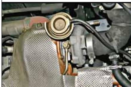
**«Горячая» часть турбокомпрессора прикрыта защитным экраном**
