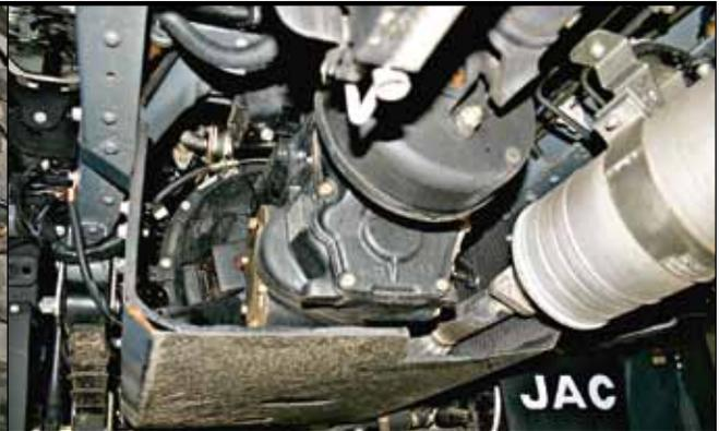
**5-ступенчатую коробку передач и картер сцепления снизу закрывает защита. Заодно и от грязи с дороги экранирует**
