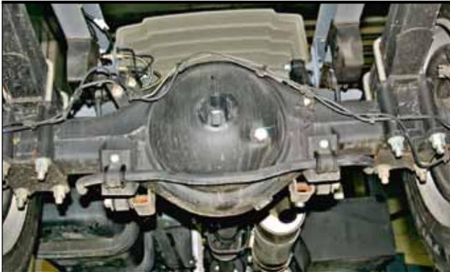
**В подвеске заднего моста установлен стабилизатор поперечной устойчивости. Для машины с «будкой» это благо**
