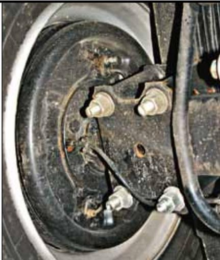
**В барабанных тормозах задних колес – по два гидравлических цилиндра**
