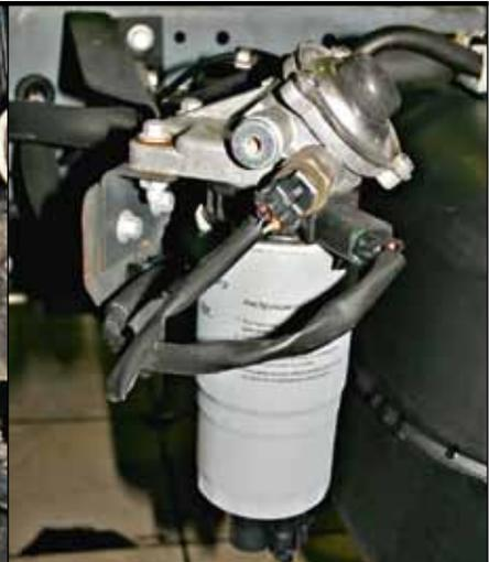
**Топливный сепаратор-отстойник поможет сберечь форсунки от воды**
