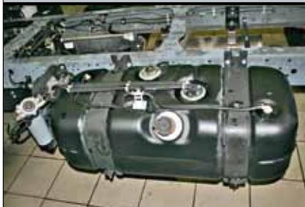
**100-литровый топливный бак и фильтры закреплены на раме слева**
