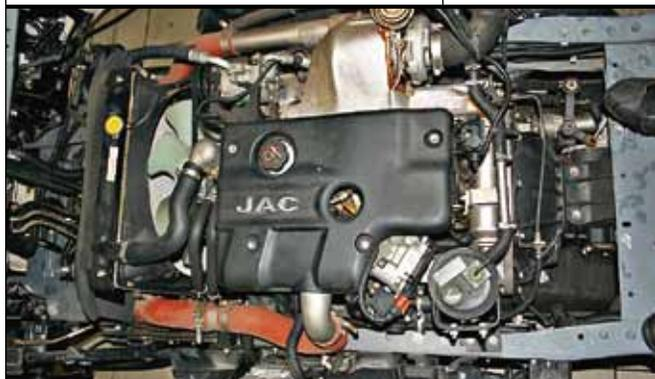
**На JAC N56 ставят широко применяемый в мире и проверенный временем 2,8-литровый мотор разработки Isuzu**
