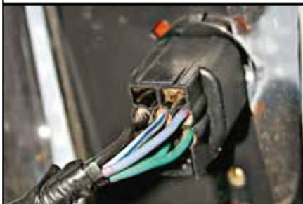
**На последних партиях машин колодки разъемов закрыты герметично**
