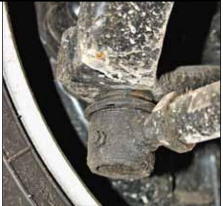
**Шарниры рулевых тяг надо шприцевать, заменяя консистентную смазку**
