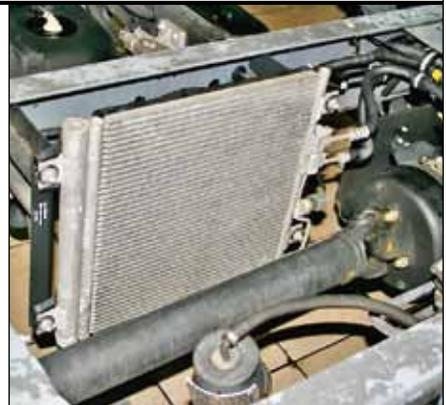
**Радиатор кондиционера установлен внутри рамы слева: здесь чище**
