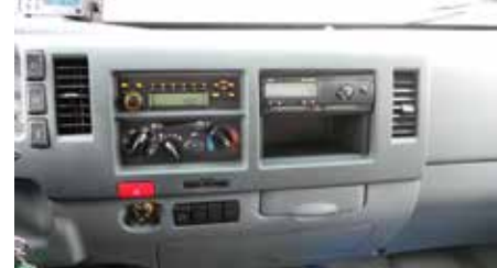
Гнездо размера 1DIN занято тахографом
