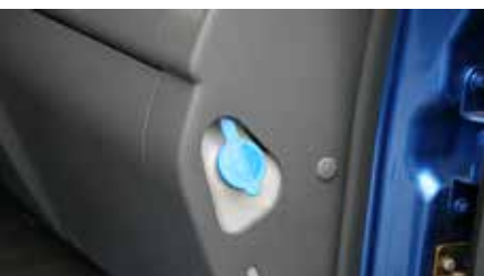
Открыв правую дверь, получаем доступ к бачку стеклоомывателя
