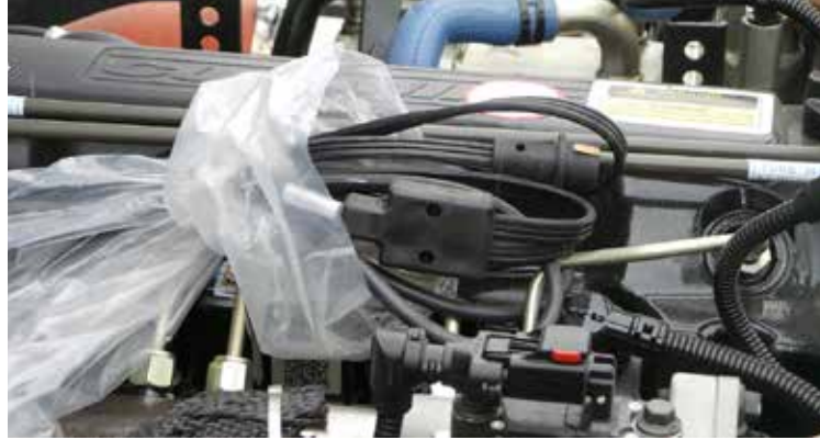
Провод штатной системы электроподогрева от внешнего источника на 220 В
