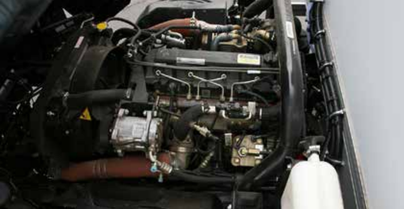
Кабина откидывается на большой угол, открывая доступ к двигателю
