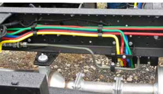
Пневмоприводы выполнены из цветного нейлона
