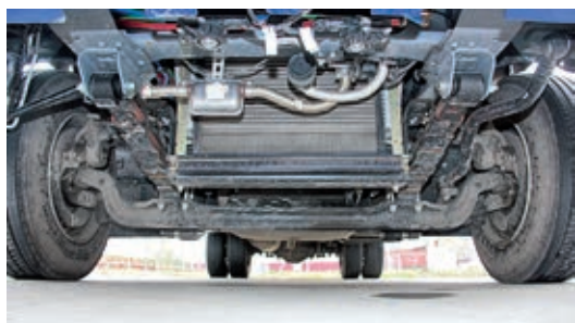
Трансмиссионная перспектива спереди и сзади, радиатор с противомоскитной сеткой
