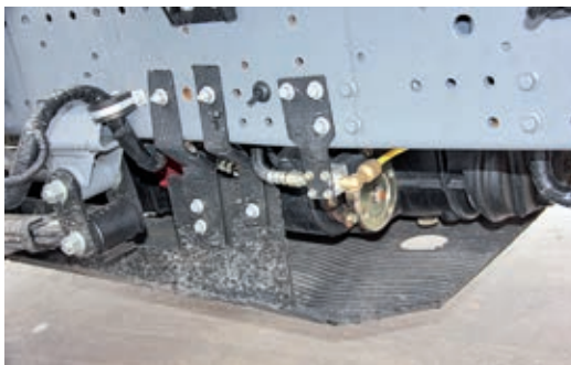
Длинная защита картера двигателя и КП, хорошо виден выходной фланец КОМ
